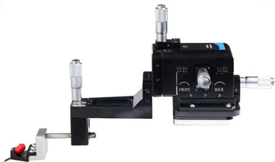
Микропозиционер для ВЧ-измерений
